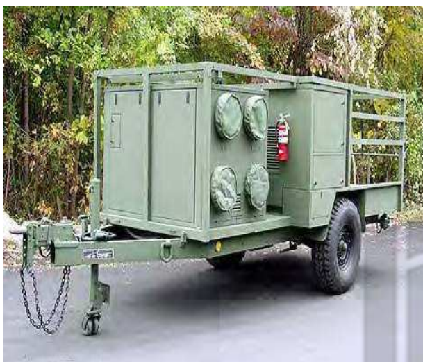
شکل ۱۷-۱ واحد تهویه هوای سیار
