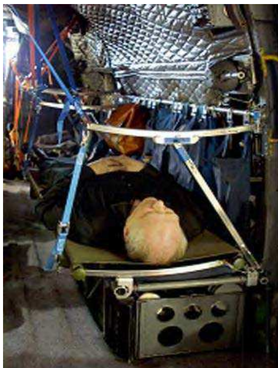
شکل ۲۵- ۵ انتقال مصدومان توسط هواپیماهای باری یا نظامی با تعبیه فضاها و تخت‌های خاص در بدنه داخلی آنها
